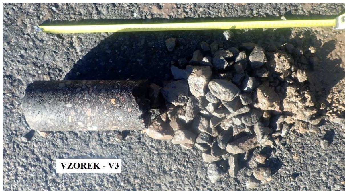
Obr. 5 - Jádro vývrtu Vzorek – V3 (in situ).
