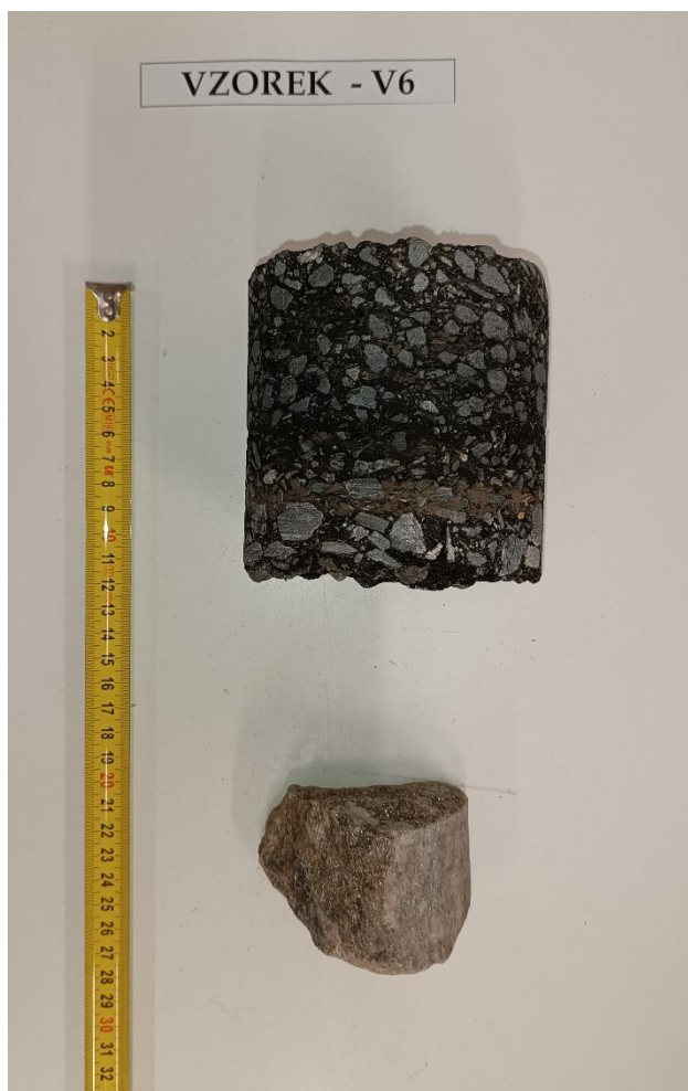
Obr. 12 - Jádro vývrtu Vzorek – V6 (laboratoř).
