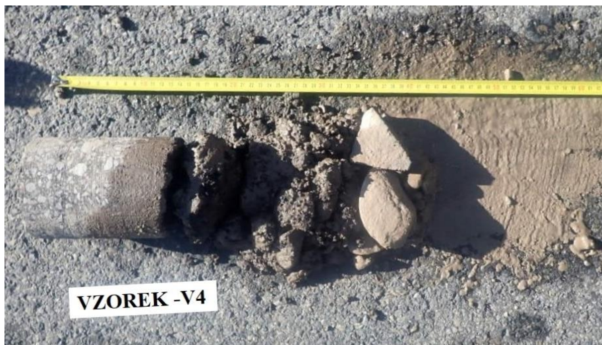
Obr. 7 - Jádro výtvtu Vzorek – V4 (in situ).
