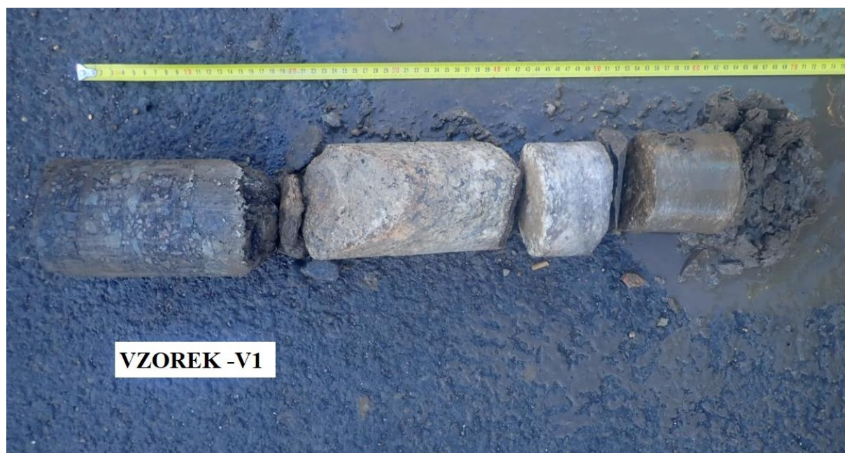
Obr. 1 - Jádro vývrtu Vzorek – V1 (in situ).
