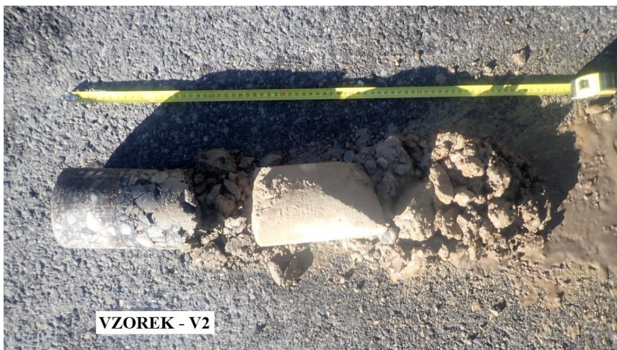
Obr. 3 - Jádro vývrtu Vzorek – V2 (in situ).
