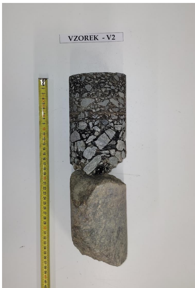
Obr. 4 - Jádru vývrtu Vzorek – V2 (laboratoř).
