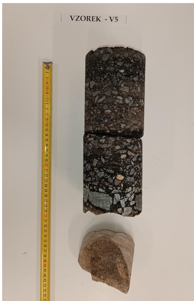
Obr. 10 - Jádru vývrtu Vzorek – V5 (laboratoř).
