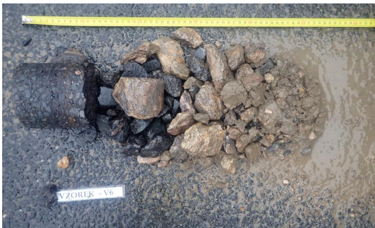
Obr. 11 - Jádro vývrtu Vzorek – V6 (in situ).
